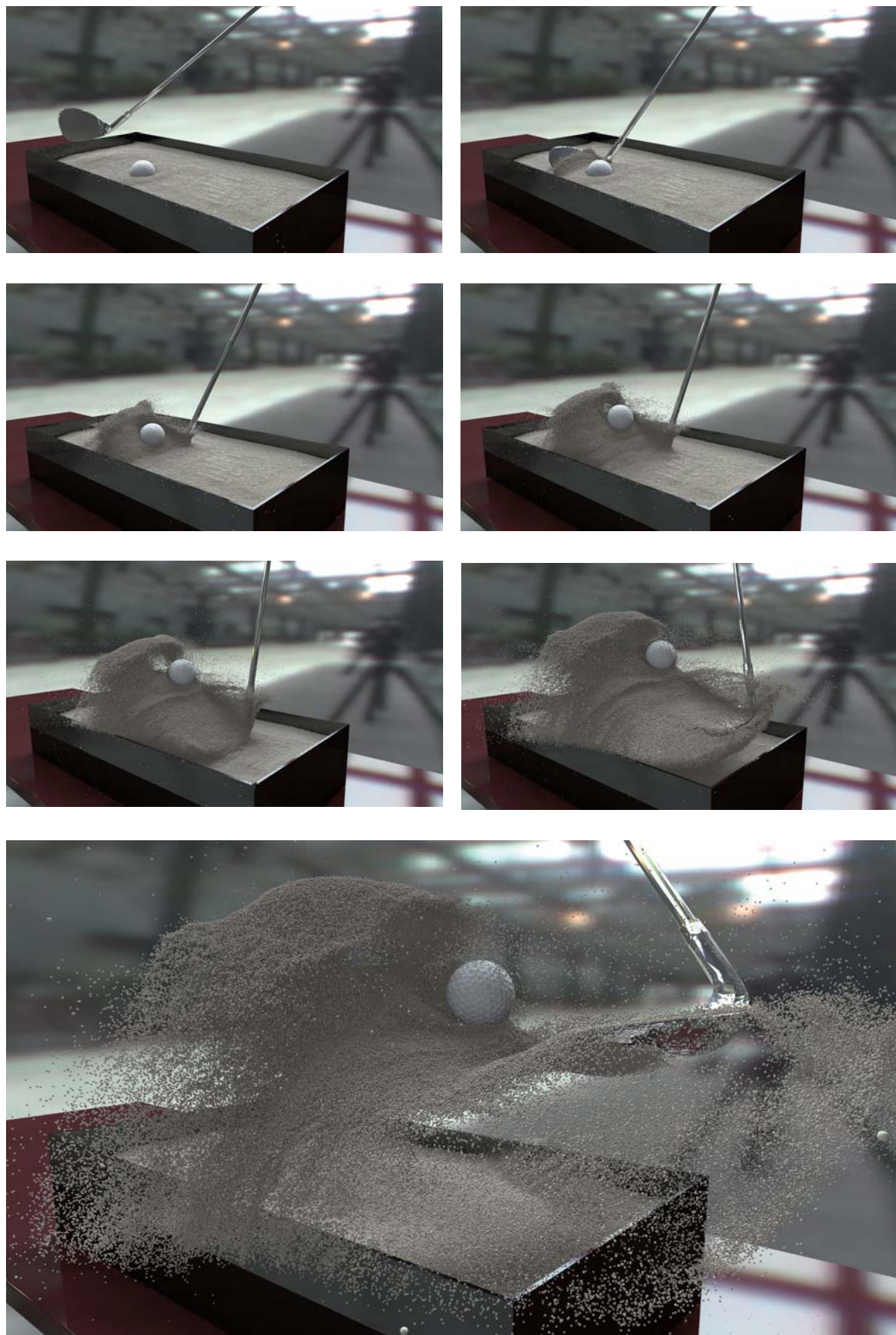
図 5.5 64 GPU を用いた 1,670 万個の粒子による大規模バンカーショット計算
