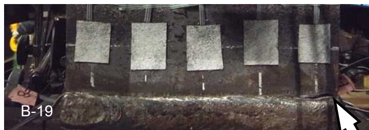
溶接始末端部の溶接止端から延性亀裂が進展
