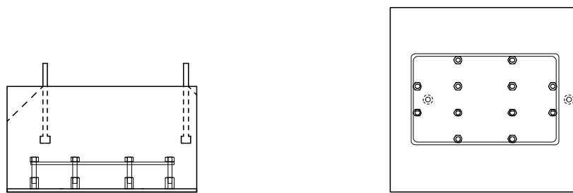
図 2.2 試験体コンクリートの配筋状況
