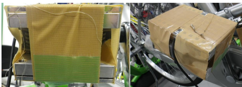
図 4. 17 ペダルとロードセルの接着部分の様子
