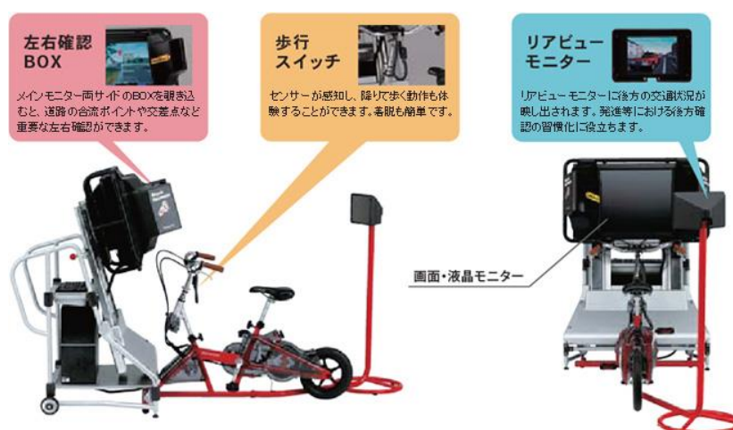
図 2.5 Honda 自転車シミュレータ(ハードの特徴) 6)
