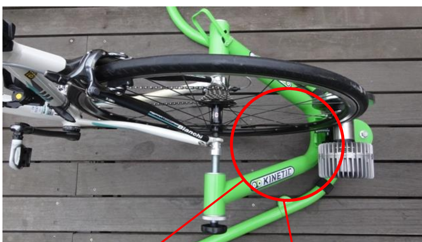
図 3. 8 完全固定式サイクルトレーナ 54)
