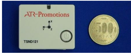
図 3.6 小型無線多機能センサ TSND121 の外観
