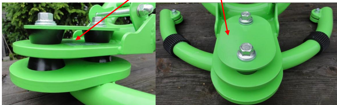
図 3. 9 左右に傾き可能な仕組みのサイクルトレーナ 55)
