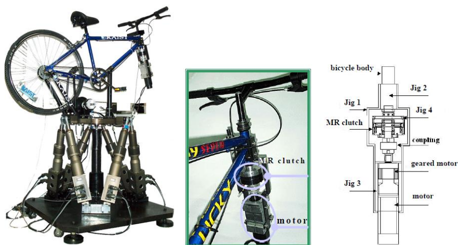
図 2.10 6 軸スチュアートプラットフォーム&ステアリング反力機構を用いた KAIST interactive CS
