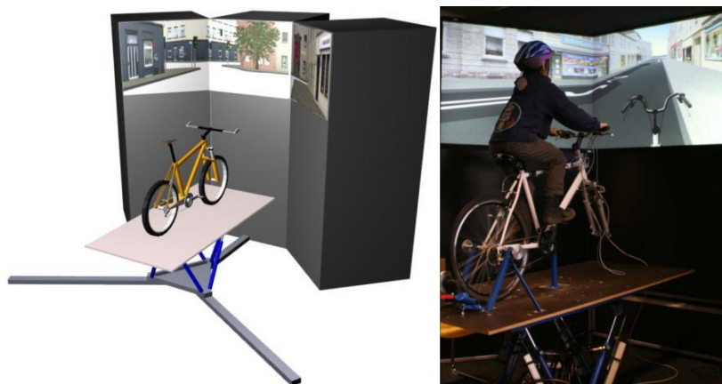
図 2.11 6 軸スクウェアプラットフォームを用いた FIVIS Bicycle Simulator
