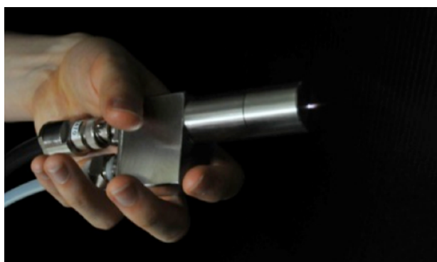
Figure 3-37 マルチガスプラズマジェットの放電の様子
