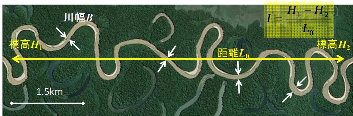
図2-6 川幅と縦断河床勾配の解析例
