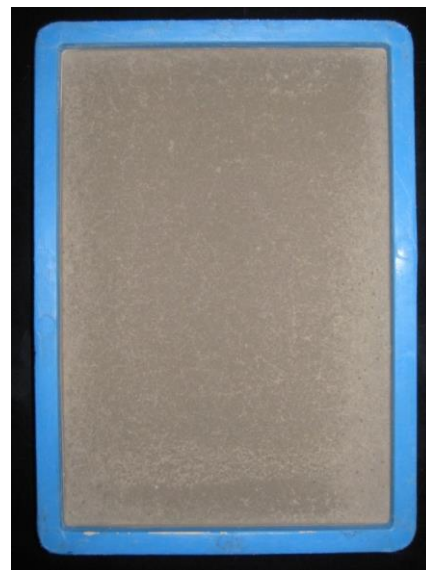
Fig.5-17 硬化前の表面状態 (材齢 5 分) Fig.5-18 硬化後の表面状態 (材齢 2 時間)
