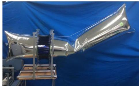
図 7 バルーン型ジャコメッティアーム 2 号機の 1 節を用いた指令角度と実際の角度の比較実験の様子
