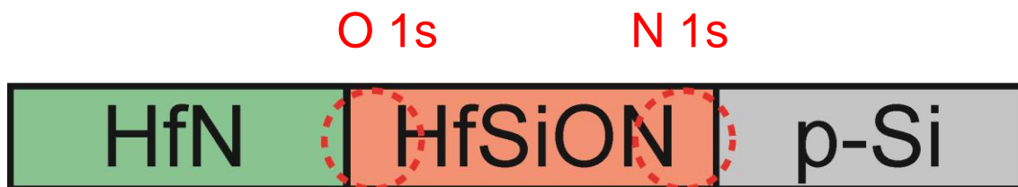
図 4.33 Ar スパッタによりエッチングを行って露出した表面の XPS 測定による O1s および N 1s スペクトルの概略図
