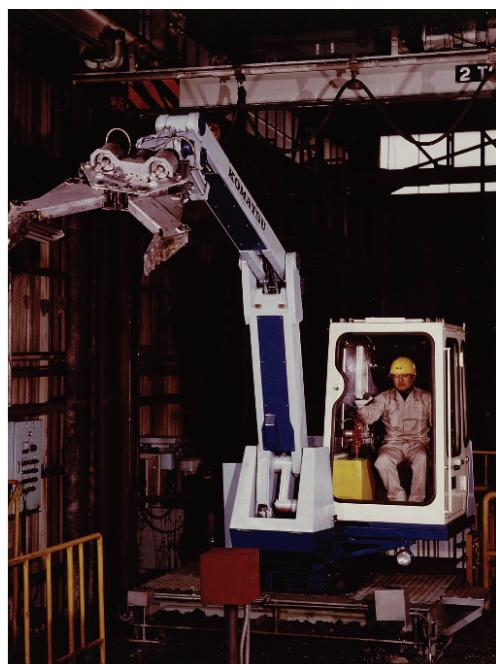
図 1.7 重量物ハンドリングマニピュレータ RCL-06, 15 (コマツ)
