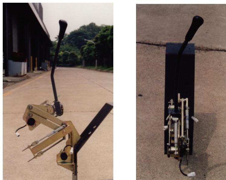
図 5.10 試作マスタマニピュレータ
