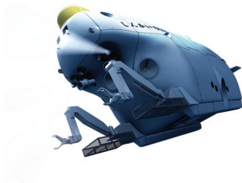
図 1.3 深海探査船用マニピュレータ
