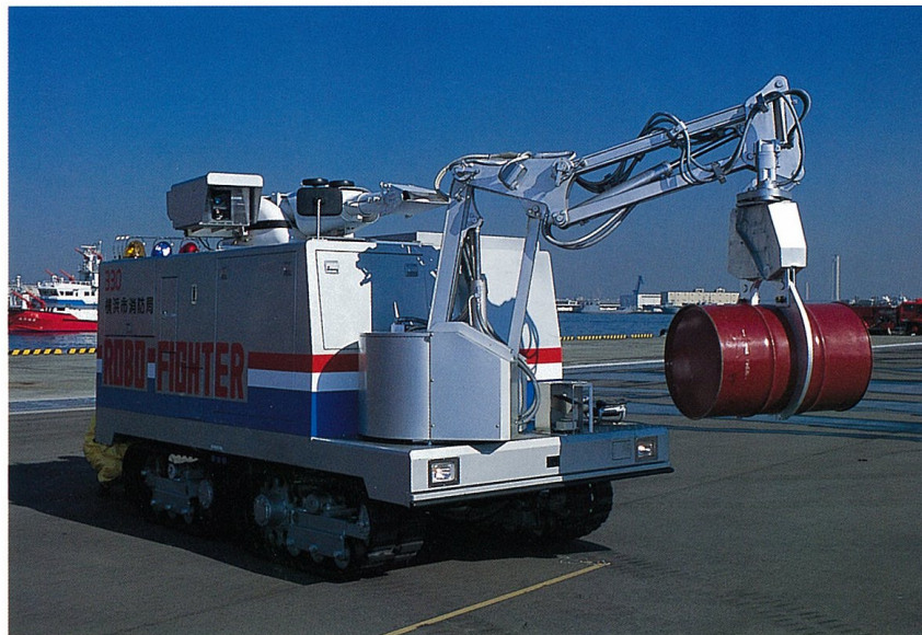
図 4.15 石油コンビナート火災対応無人放水車（横浜市消防局）
