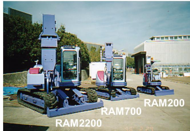
図 4.13 量産モデルの系列化（過般重量 2kN～22kN）
