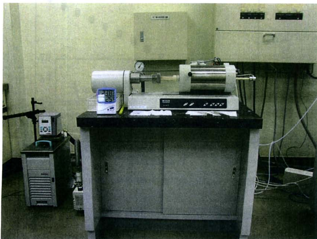
Fig.5.1-3 熱膨張計 装置全体
