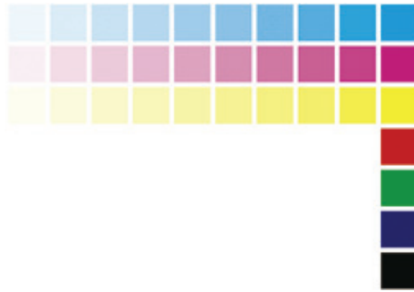
図 5.3 Neugebauer 原色 8 色と C,M,Y の単色階調ステップ
