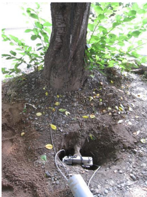
写真2.7 肥大量測定装置取り付け状況
