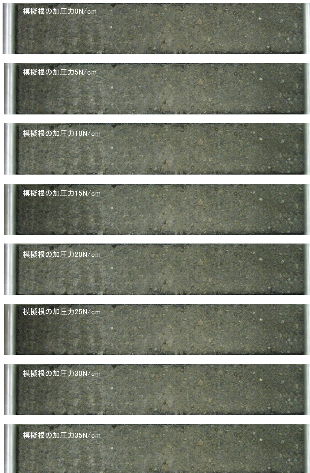
写真3.13 アスファルト舗装表面のひび割れ状態の一例(模擬根直上の砂層の厚さ0mm) 1/2
