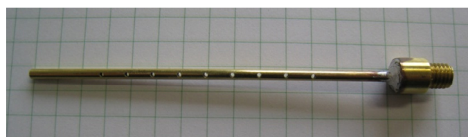
写真5.1 模擬地下茎軸部
