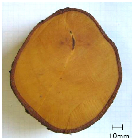
写真3.2 力学的性質測定に用いたソメイヨシノの根の断面
