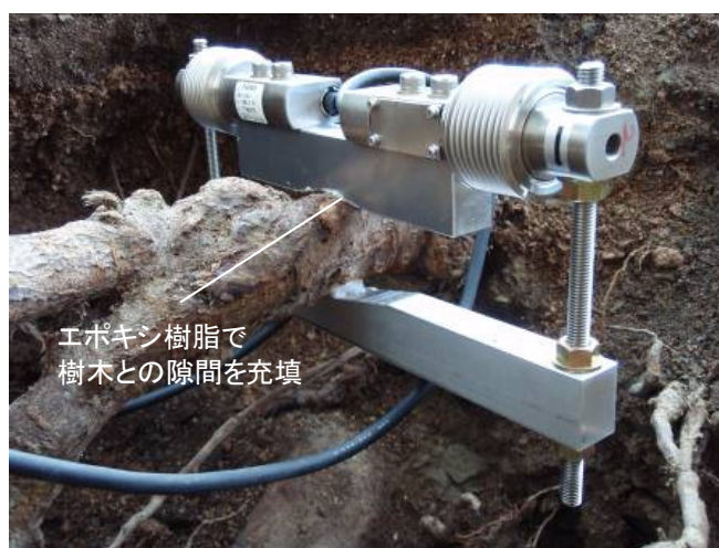
写真2.6 肥大力測定装置取り付け状況
