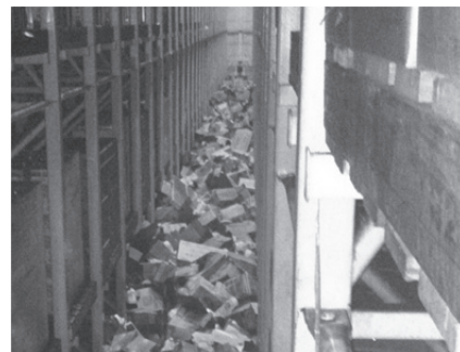
写真1 地震時の積荷落下状況
