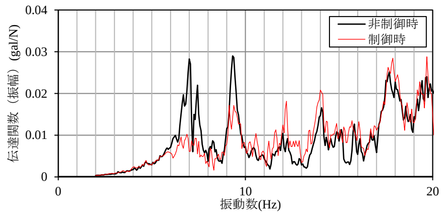
図 4.3.8 スイープ加振時 (2~20Hz) の制御対象床中央のアクセラランス
