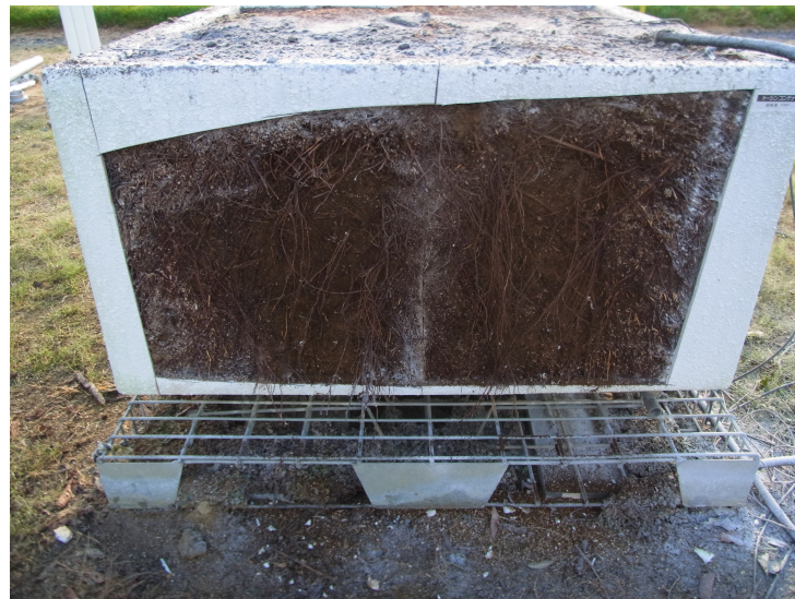
図 2.14 蒸散計測を行ったケヤキ供試木と同サイズのコンテナ，かつ，ほぼ同サイズのケヤキの根分布（2012 年 9 月）。
