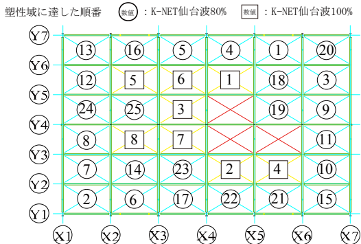
図 16 耐震天井試験体の屋根ブレース材の塑性化順序
