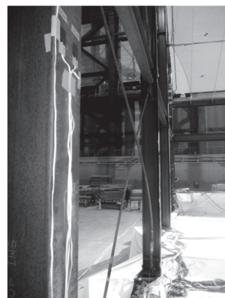
写真2 K-NET 仙台波 80%加振後の壁ブレースの座屈変形
