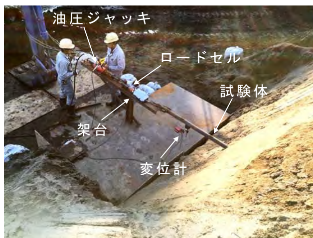
写真 4.4.3 引抜き実験状況（現場 TK）
