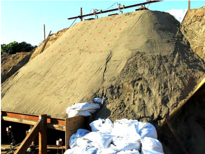
付 A 写真 2.1 除荷ステップ 10mm-移動層を斜め正面から見た状態
