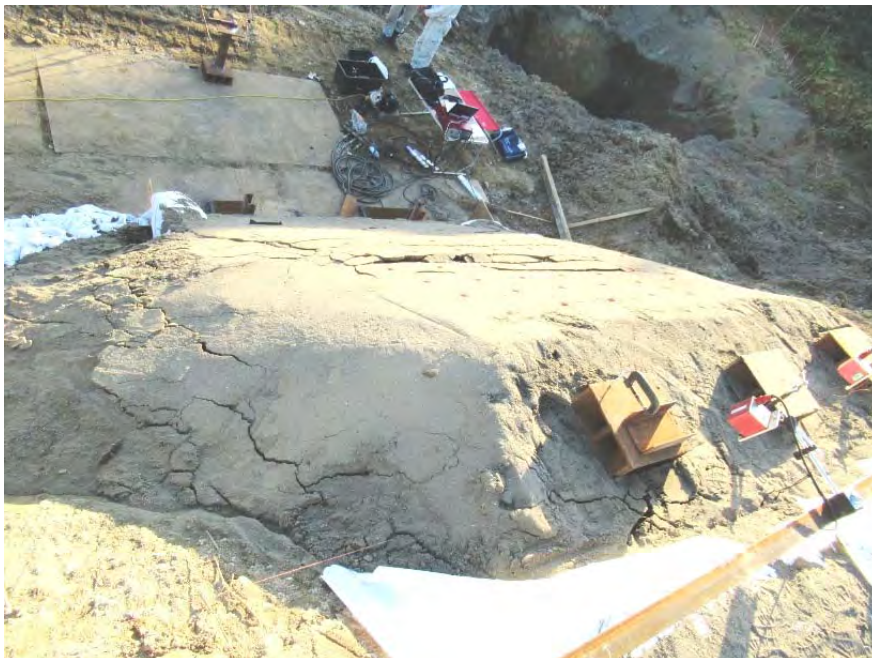
付 A 写真 2.6 最終除荷ステップ 90mm-移動層を法肩から下方に見た状態
