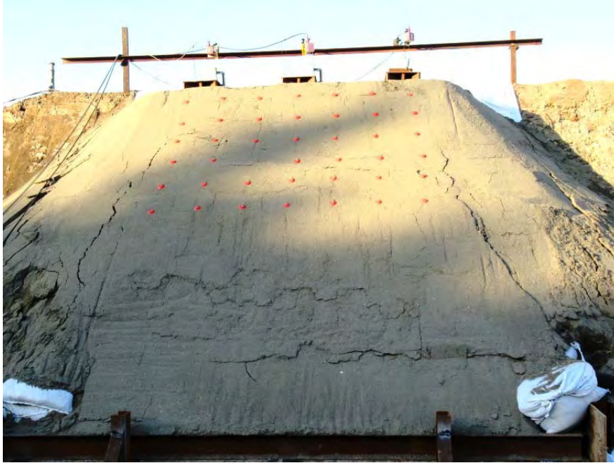
付 A 写真 2.5 最終除荷ステップ 90mm-移動層を正面から見た状態
