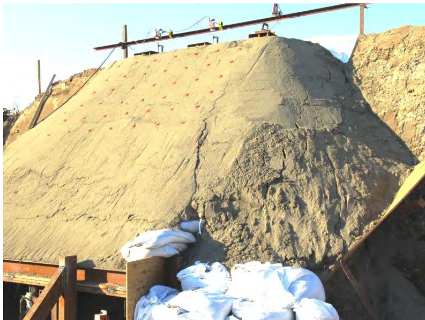
付 A 写真 2.3 除荷ステップ 60mm－移動層を斜め正面から見た状態
