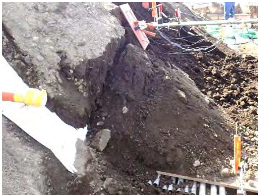
写真 5.3.6 実験終了時における移動層の側方
