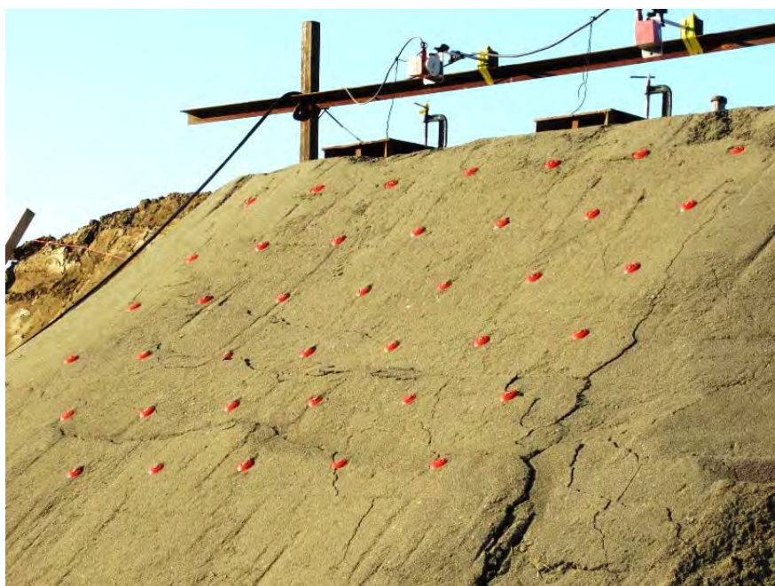
付 A 写真 2.4 除荷ステップ 60mm－移動層中央から法肩のクラック分布
