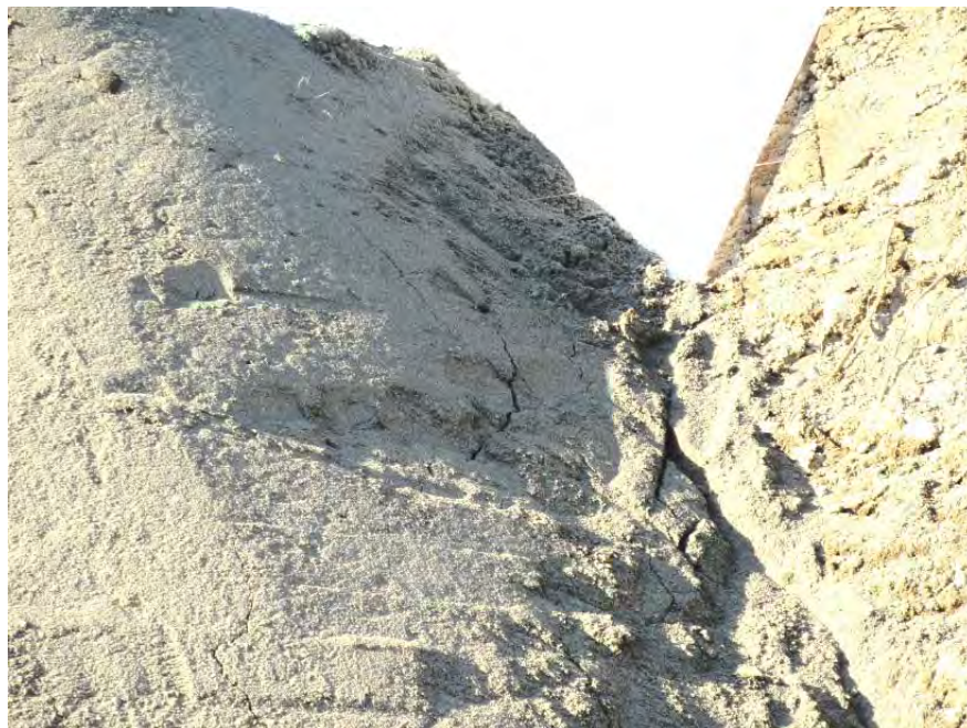
付 A 写真 2.2 除荷ステップ 10mm-すべり面に生じたクラック（法肩）
