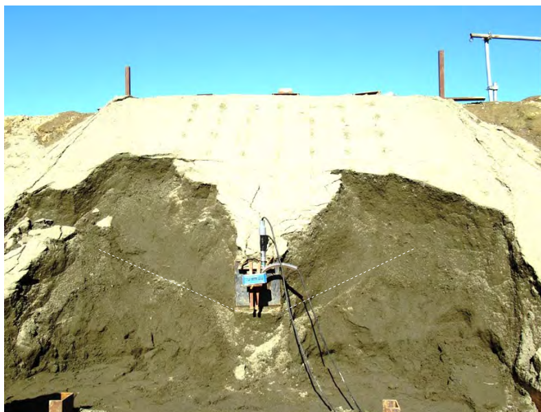
写真 3.3.7 受圧板が支持する移動層正面 (TK-300)
