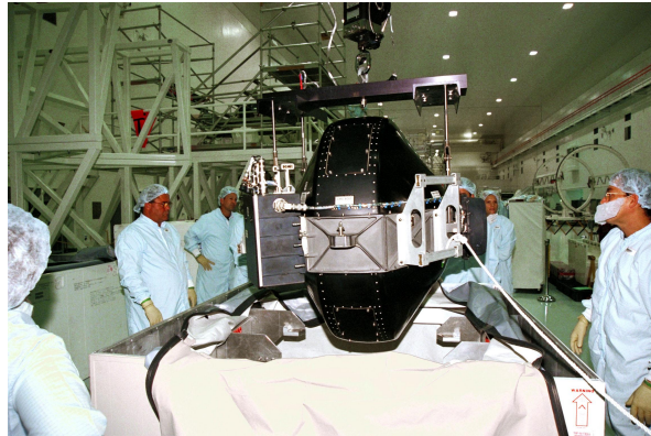
図 1.8: ISS に搭載された DGCMG 外観
