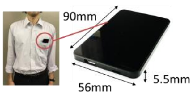
図 35 提案システムのターゲットノードと固定局
