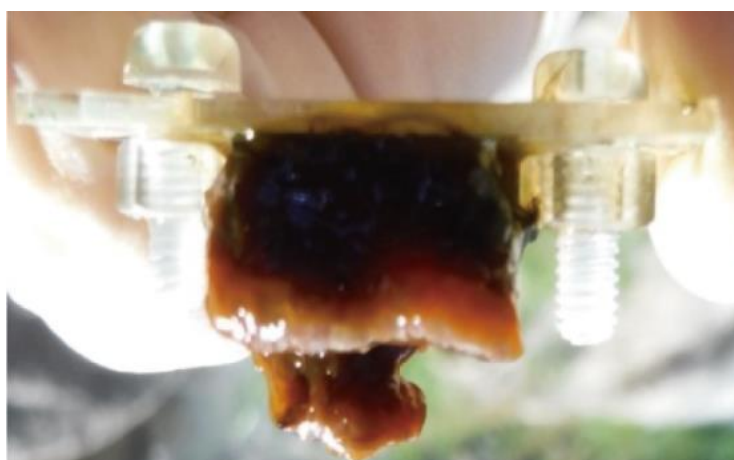
Figure 3-12 装置 1 の 730 nm 波長光培養後の微生物マットの層構造形成 微生物マットの上層約 3 mm が茶色の層、その下に約 2 mm のオレンジ-ピンクの層が形成された。これは他の装置でも見られた。
