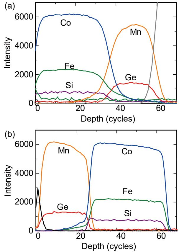
図 5 深さ方向の AES プロファイル。(a)  $\text{Mn}_3\text{Ge}/\text{CFS}$  の順で積層した試料 (b)  $\text{CFS}/\text{Mn}_3\text{Ge}$  の順で積層した試料
