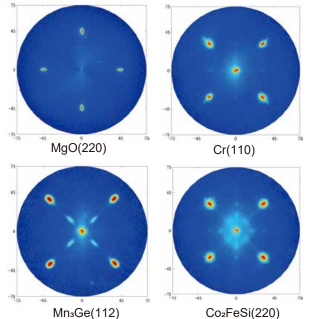
図 2 CFS(100nm)/Mn<sub>3</sub>Ge(100nm) の試料の極点図解析
