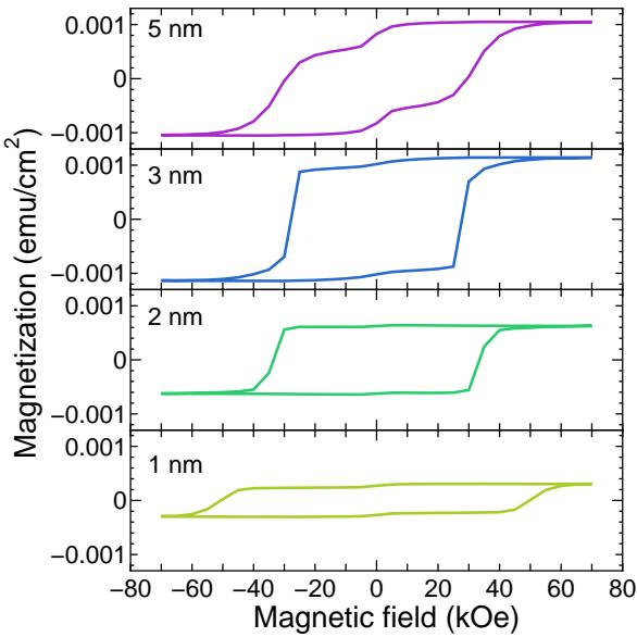
図 4 様々な CFS 膜厚  $t$  を持つ  $\text{CFS}/\text{Mn}_3\text{Ge}$  二層膜の垂直方向の磁化特性
