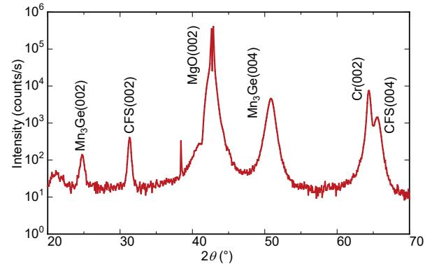
図 1 CFS(100nm)/Mn<sub>3</sub>Ge(100nm) の試料の XRD  $\theta$ - $2\theta$  パターン
