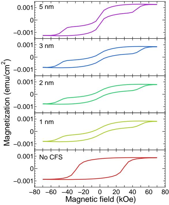
図 3 様々な CFS 膜厚  $t$  を持つ  $\text{Mn}_3\text{Ge}/\text{CFS}$  二層膜の垂直方向の磁化特性
