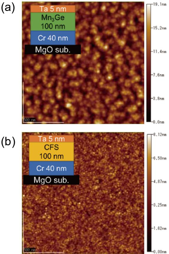
図 6 キャップした (a)Mn<sub>3</sub>Ge と (b)CFS の AFM 像
