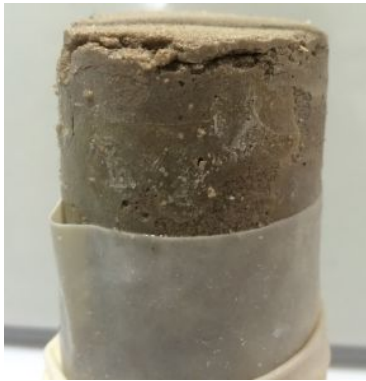
図-4 ケース A の海水曝露 56 日目に見られた供試体の剥離
