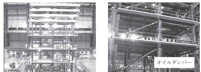
(a) 耐震試験体 (b) 制振試験体 図1 E - ディフェンスによる実験状況と試験体名称
