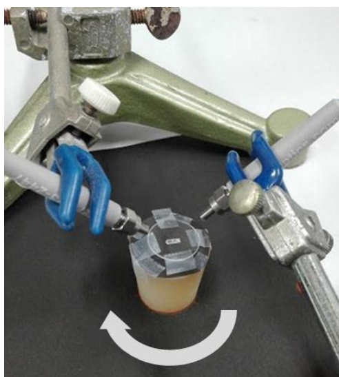
図 4-20 CT 吸収の異方性測定の設定: 蛍光光度計に連結した光ファイバーに対し、2,6-Dimethoxybenzoic acid 単結晶の向きを変化させながら燐光ピーク強度を測定した
