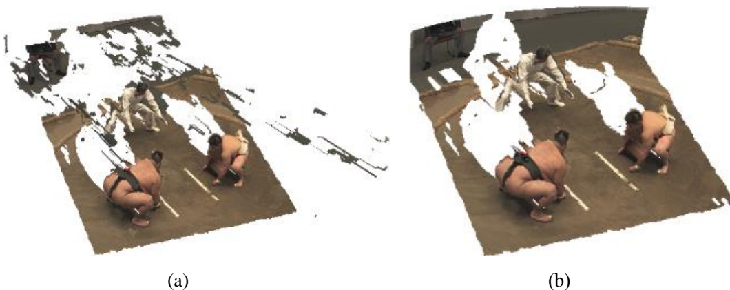
(a) (b) 図4.5 信頼度 R による3次元モデルの補正 (a) 補正なし (b) 補正あり
