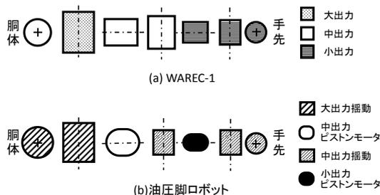
図1 WAREC-1と油圧脚ロボットの
