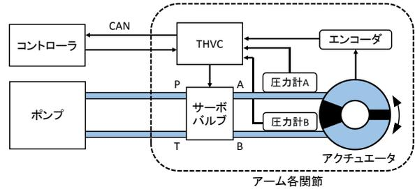
図10 油圧脚ロボットの制御系
