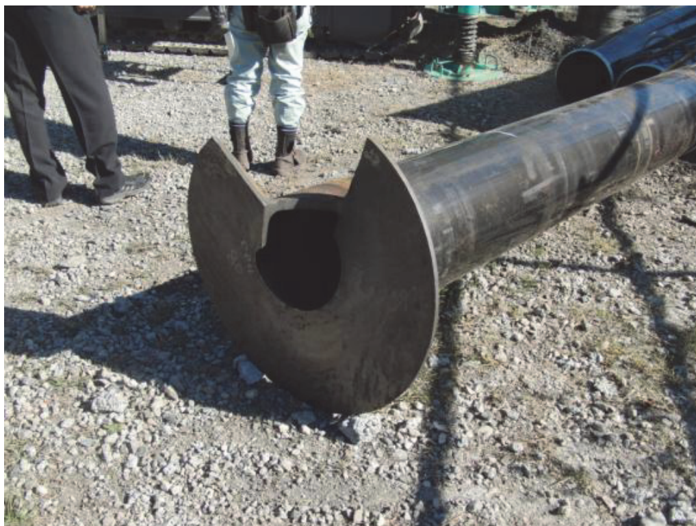
図 6-4 高架橋模型に用いた鋼管杭（エコパイル）
