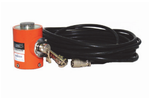
図 2-18 ロードセル (東京測器社製 CLP-50kNB)
