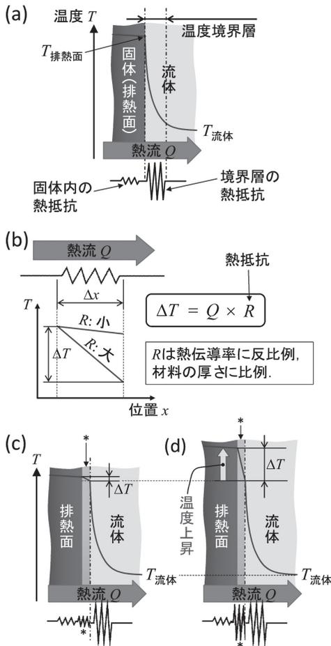
図2 (a) 固体-流体界面の断面模式図、
