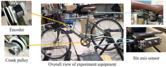
Fig. 6 Overall view of experiment equipment and sensors 率の男女平均値を用いてクランク回転数が 57.0[rpm]の時に移動体の速度が 4.4[km/h]となるように定めた. 図 4 にクランク回転数[rad/s]と移動体の速度 v [km/h]の関係を示す. なお, 直進安定性を考慮し, 5[rpm]以下に不感帯を設けた.
