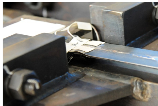
(d) Girder local buckling (1/33rad-1cycle)
