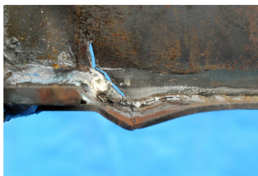
(d) Fracture condition of beam end (After testing)
