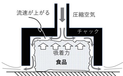
図 2 ベルヌーイチャックの原理
