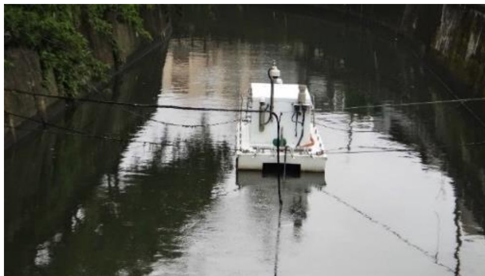
写真 6-1 呑川に設置された水流発生装置
