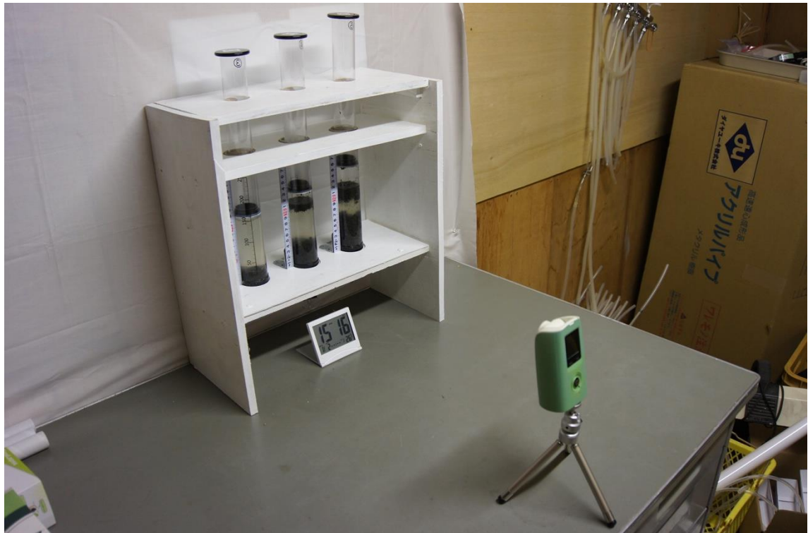
写真 5-2(1) 嫌気性ガス生成速度試験の様子 (Case1~3, 開始から 15 時間 16 分後)
