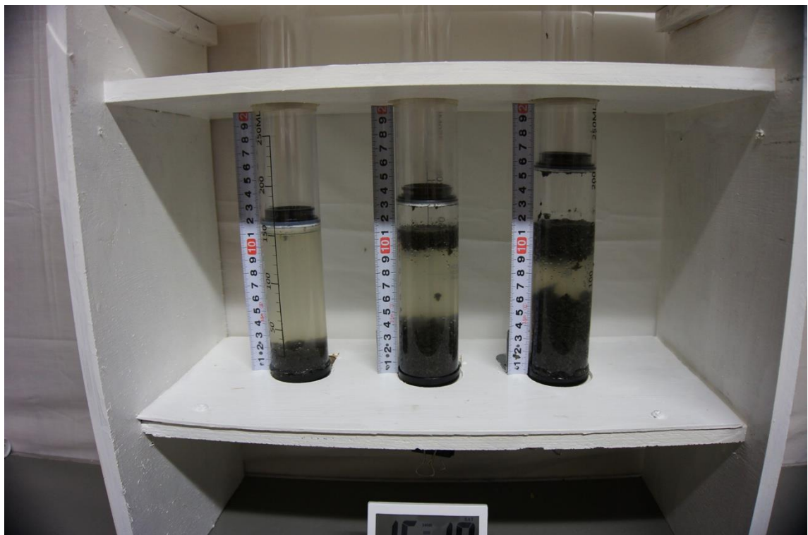
写真 5-2(2) 嫌気性ガス生成速度試験の様子 (Case1~3, 開始から 15 時間 16 分後)
