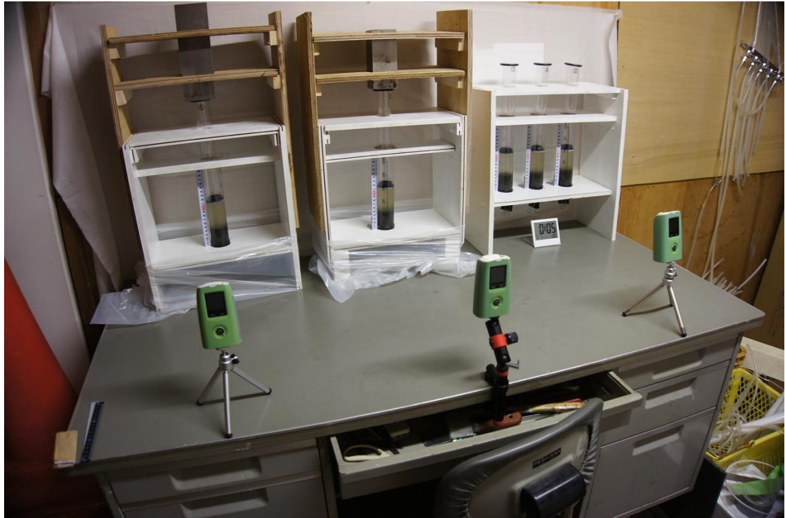
写真 5-2(2) 嫌気性ガス生成速度試験の様子 (Case1' &6~9, 開始から5分後)
