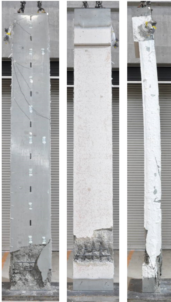
非加熱面 加熱面 断熱面 写真 4- 3 実験後の試験体(H1-03-42)
