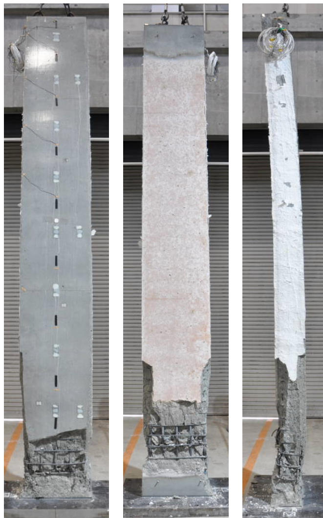
非加熱面 加熱面 断熱面
