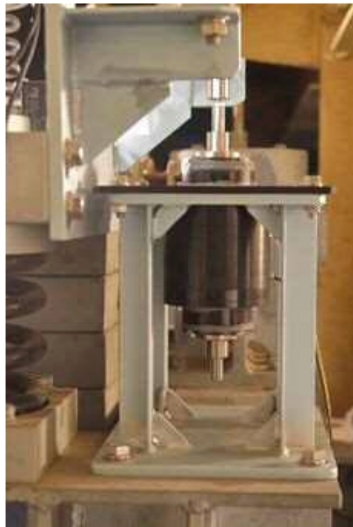
図 5-5-2 発電型 TMD (左) と電磁減衰装置 (右)
