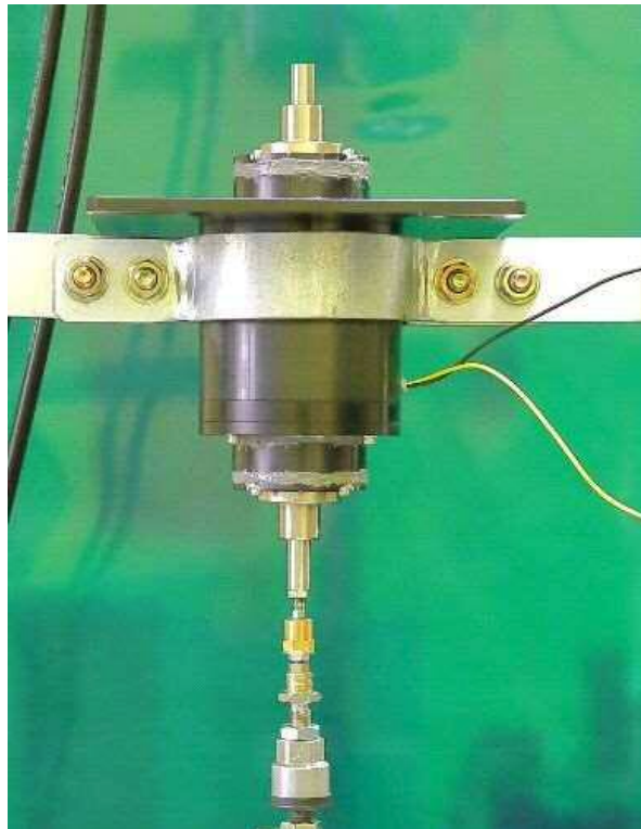
図5-2-3 加振装置への電磁減衰装置の設置図
