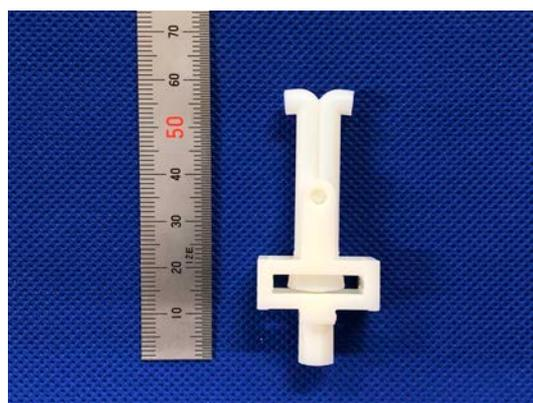
図2 試作したアクチュエータ
