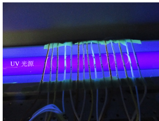
図 1 照射線源に対する高強度化学繊維ロープの設置状況
