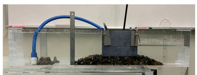
図-3 ケース 1 (20cm 堰) の実験の様子
