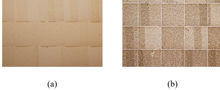
図 3.15 (a) 補正前, (b) 補正後の CGH プリンタ印刷パターン
