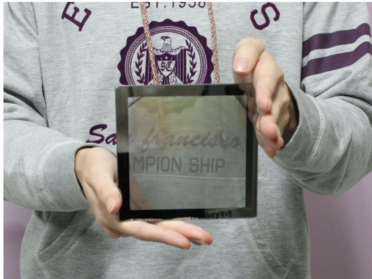
図 4.11 ガラス基板上に印刷したバイナリ振幅マスク
