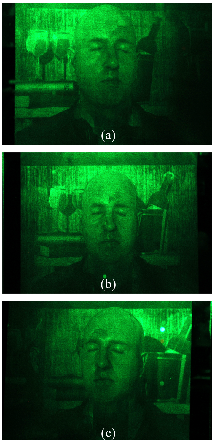
図 6.6 (a) 左 (b) 正面 (c) 右から撮影した深度可変法で計算した CGH の光学再生像
