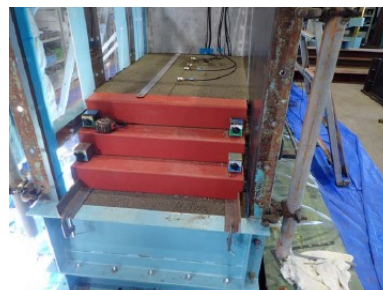
(d) Construction of layer of soil
