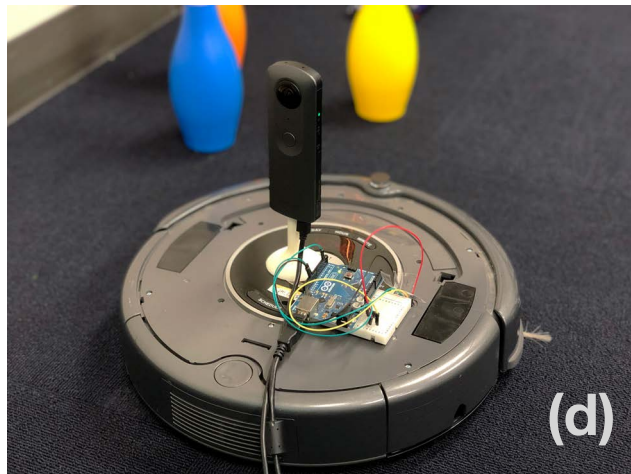
図 5.21: (a) 実際の部屋の様子 (b) 全天球カメラ搭載 Roomba と操縦者 (c) 投影を行う前の凹型半球面コントローラ (d) 全天球カメラ搭載 Roomba
