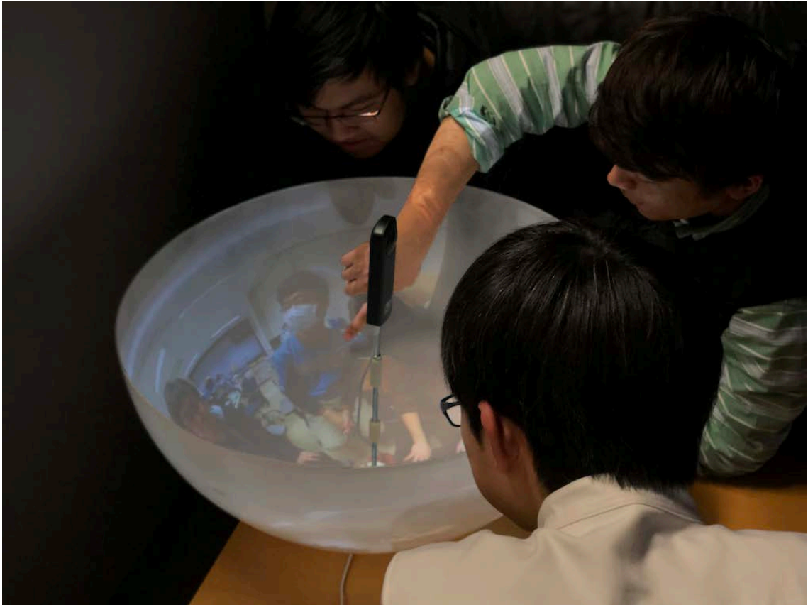
図 5.24: 凹型半球面ディスプレイと全天球カメラの組み合わせプロトタイプ
