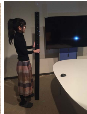
図 4.34: キャリブレーション棒を設置している様子
