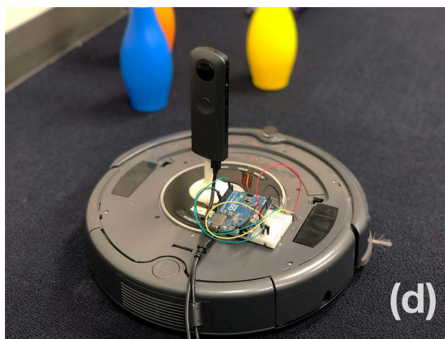
図 5.21: (a) 実際の部屋の様子 (b) 全天球カメラ搭載 Roomba と操縦者 (c) 投影を行う前の凹型半球面コントローラ (d) 全天球カメラ搭載 Roomba
