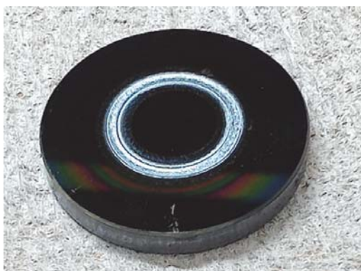
図 3.5: シリコンターゲット表面上のレーザー照射痕。
