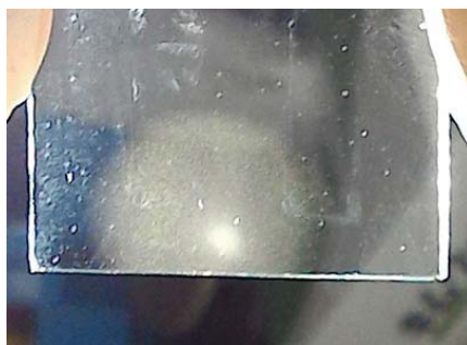
図 4.13: スライドガラス上の蒸着スポット.(200 Pa)
