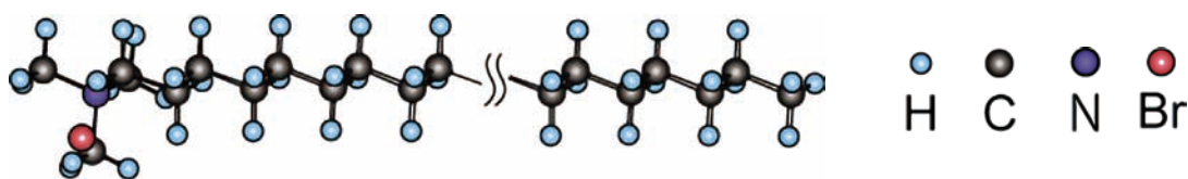
図8 界面活性剤、モノアルキルトリメチルアンモニウムブロマイド( C_nH_{2n+1}N^+(CH_3)_3Br )の構造
