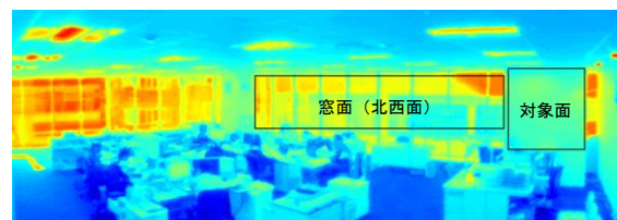
図 4.5 北西窓と評価対象面を示す屋内輝度画像
