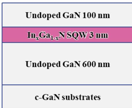
Fig. 5-2 サンプル構造
