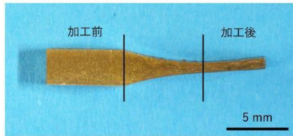
図 2.6 圧延加工止め試験片
