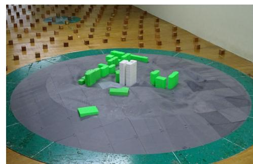
写真 1 風洞実験の様子 (地形十周辺建物)
