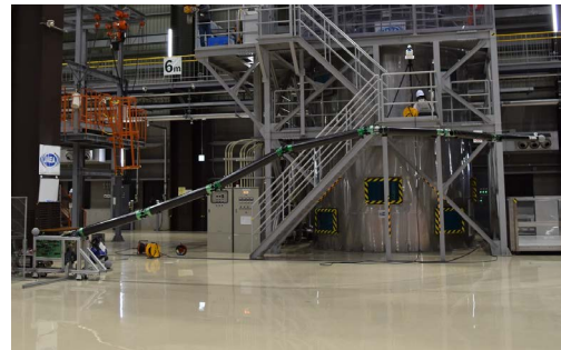
図 1 全長 10 m 長尺多関節アーム: Super Dragon
